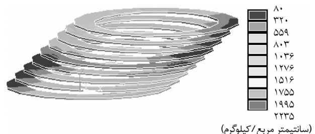
شکل ۸- توزیع تنش ون میسز پس از پایان بارگذاری قائم و برشی برای جداساز در حالت \frac{b}{r_s} = 0.25
