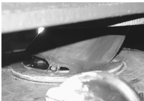
شکل ۱۳- تصویر جدا شدن لاستیک از صفحه پایینی جداساز شماره ۱ در انتهای بارگذاری شماره ۸.
